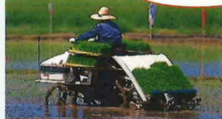
苗の長さが約10センチ、葉が3~4枚程度に なったら田植え機に苗をセットして、田植えを行う
