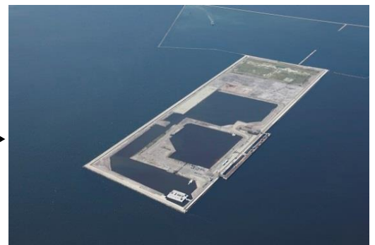
大阪湾埋め立て地 天日乾燥場で乾燥させた泥は大阪湾の最終処分場にて埋立処分を行います。
